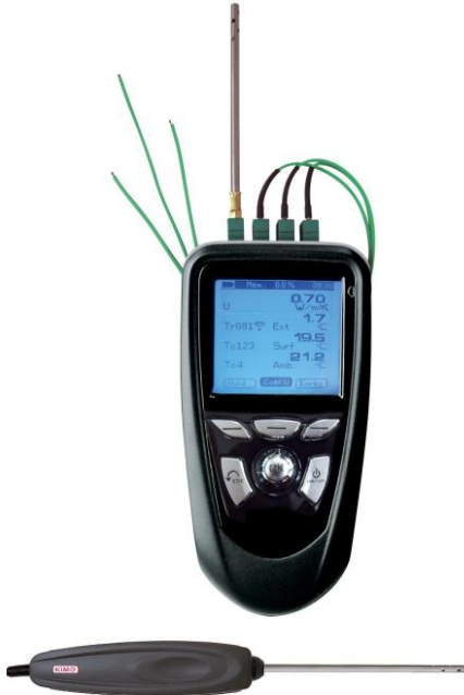
Նկ. 2. Արտաքին պատող կոնստրուկցիաների ջերմափոխանցման «Ս» փաստացի արժեքի չափման STM 200 U սարք
